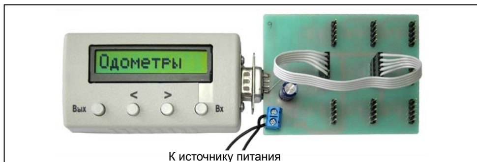
Рисунок 2. Подключение адаптера ПО5-EEPROM к программатору
